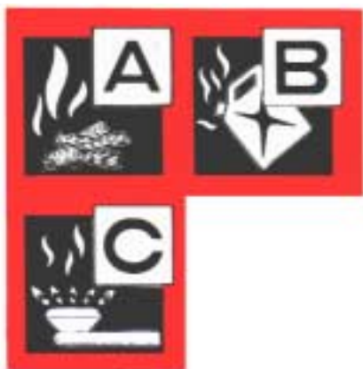
Abb. 10 Brandklassensymbole nach DIN EN 3-5
