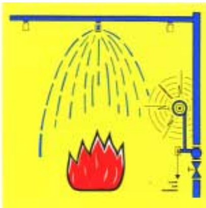
Abb. 14 Prinzip einer Sprinkleranlage – ortsfeste Löschanlage
