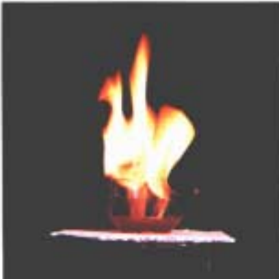
Abb. 5 Brennen einer Flüssigkeit in der Gasphase oberhalb des Flüssigkeitsspiegels
